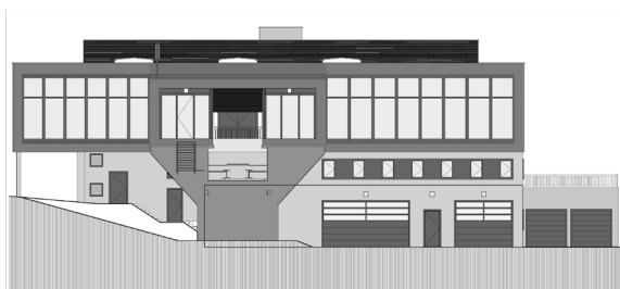
Nordansicht der Fassade mit den beiden Feuerwehrlokal-Toren im UG
